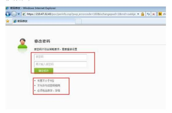
初始密码必须要求修改密码,并且必须符合密码规则:长 度不小于6位、不能与旧密码相同、必须包含数字,字母 修改完毕自动跳转控件页面
